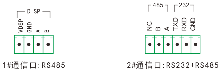
图 4.14 仪表 2 个通信接口示意图
